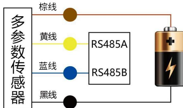
⚠ 注意：接线时一定要小心，如果电源电压过高或极性接反，将造成传感器的永久性损坏。
