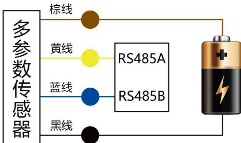
！ 注意：接线时一定要小心，如果电源电压过高或极性接反，将造成传感器的永久性损坏。
