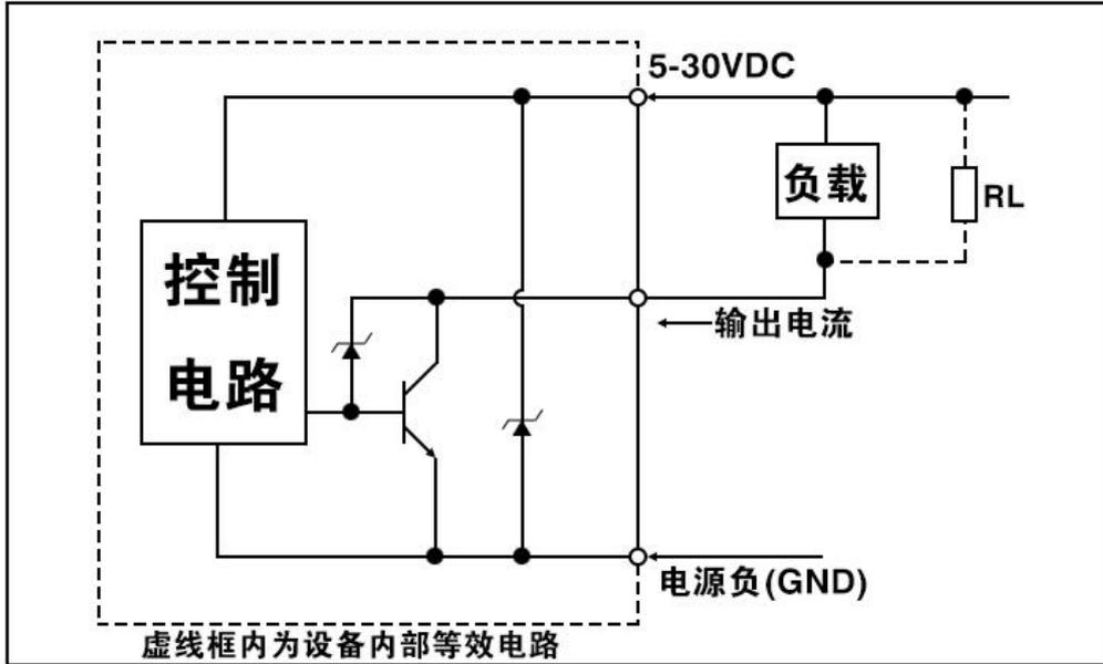
内部带上拉电阻 NPN 输出电路图如下：(RL=5.1KΩ)
