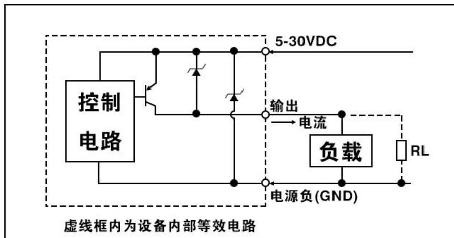
当使用电压信号时，需连接电阻  $R_L$ ，推荐阻值  $5.1\text{K}\Omega$ ，功率  $\geq 0.25\text{W}$
