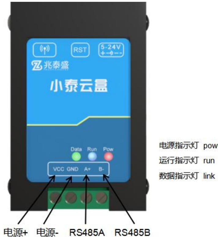
(1) 可将 485 型传感器通过 电源+ 电源- 485A 485B 连接至小泰云盒，最多连接 8 台设备。
